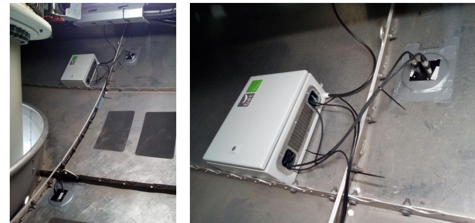
Caisson du Batmode avec les disques (support micro et connexion à distance) – Eric Morel / Ecosphère
