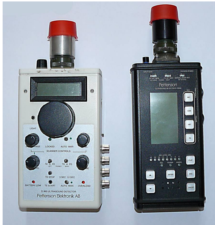
Détecteurs à ultra-sons, modèles D980 (à gauche) et D1000X (à droite) « Petterssonelektronik » Photo : Cédric LOUVET - Ecosphère
